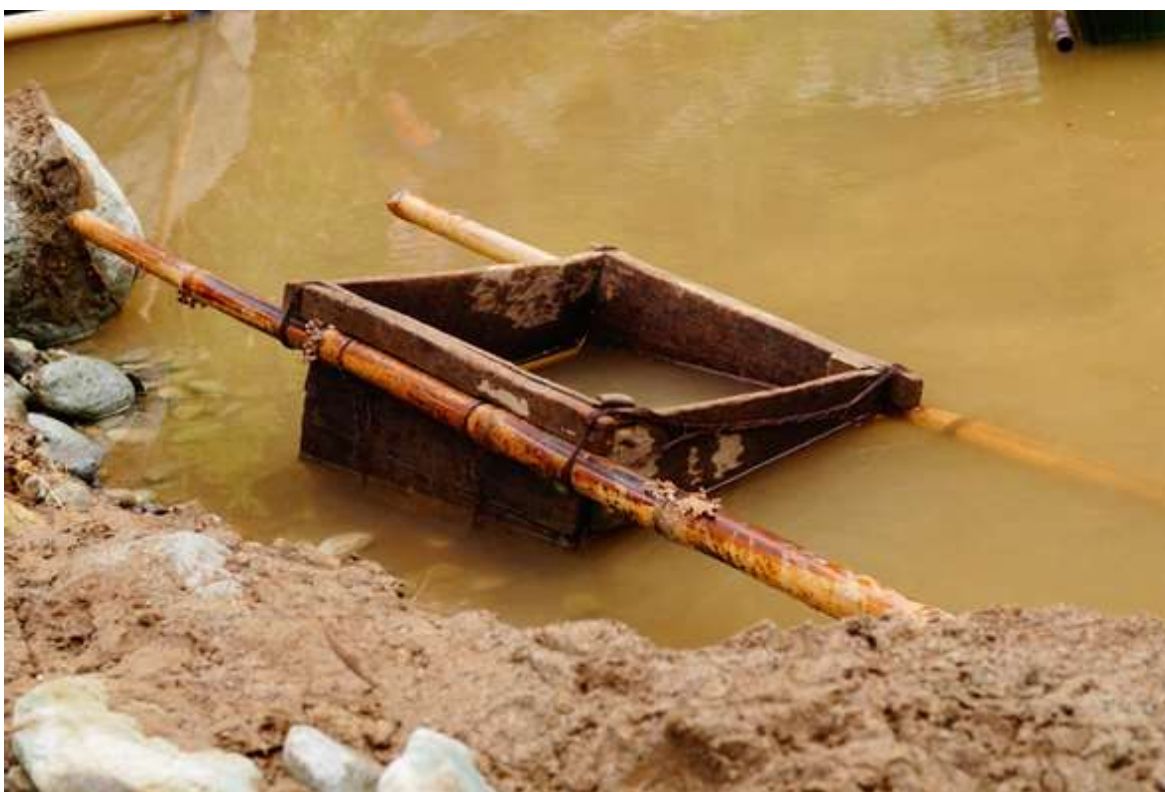
Cajón de madera y azas de guadua, para albergar piedras y arena recolectada del río. Es cargado en pareja. Fotografía: Valeria Urán Sierra.
